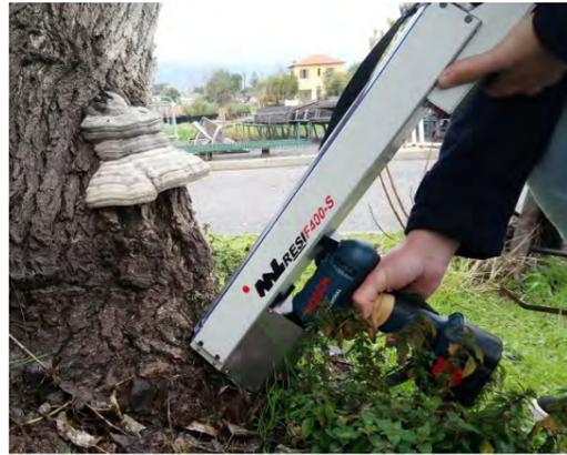
Exemple de matériel complémentaire au contrôle visuel. (A) Les mesures réalisées par le pénétromètre permettent d'évaluer l'épaisseur de bois sain et celle de bois altéré grâce à la résistance des tissus lors du passage de la mèche. (B) Courbe issue de la mesure par pénétromètre disposée sur la souche relevée.
