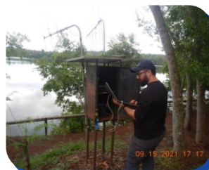
Manutenção e download dos dados de base fixa de radiotelemetria.
