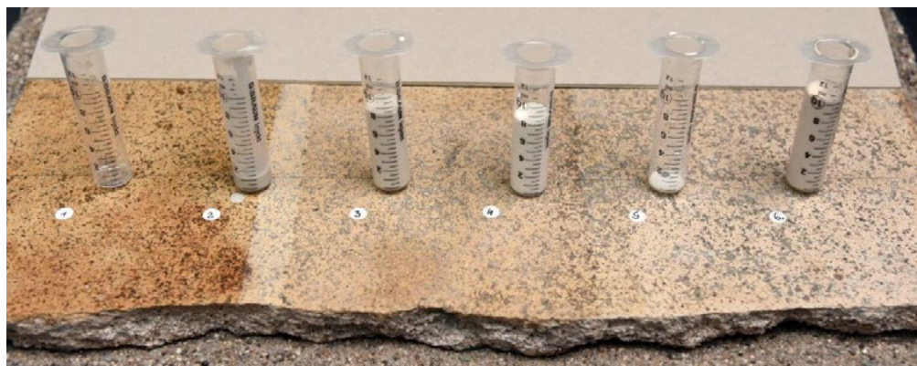
Abb. 14: Packer mit Materialproben zur Beprobung der Fließfähigkeit
