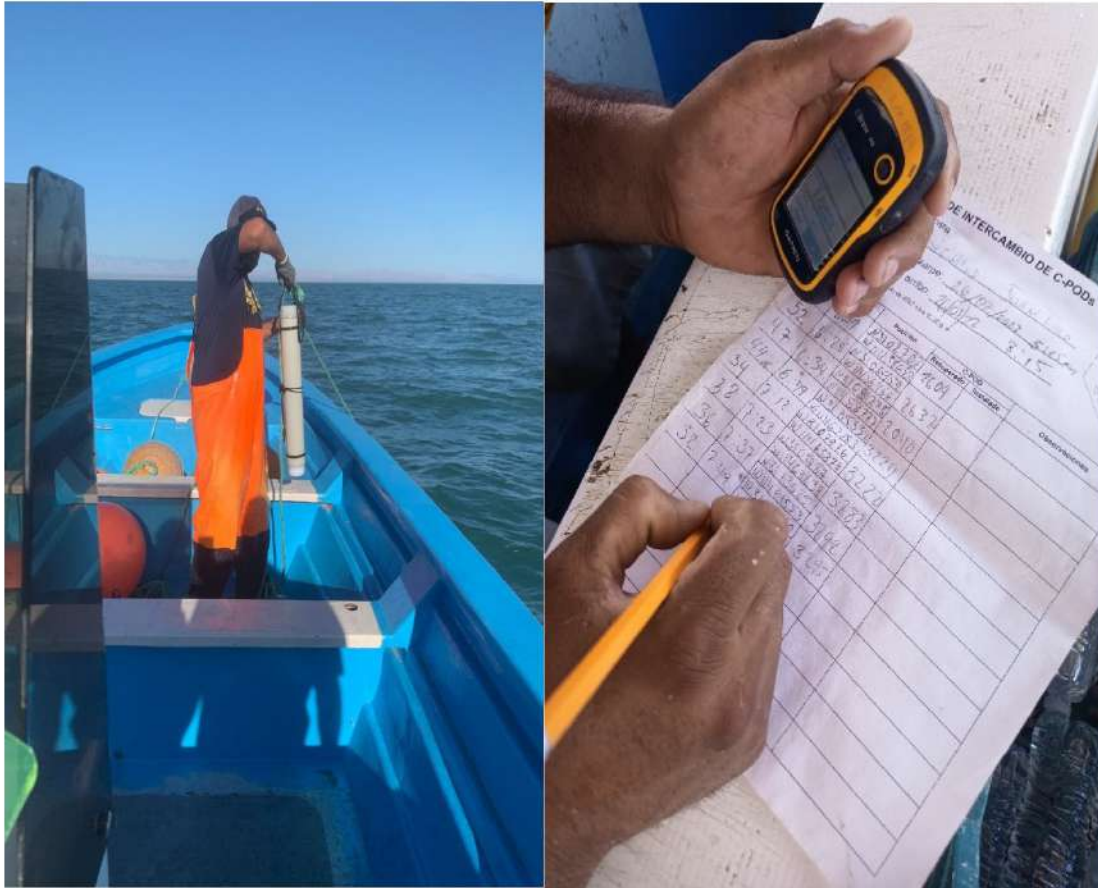
Figura 5. Maniobra de lance y recuperación de detectores con uso de GPS y llenado de bitácora.
