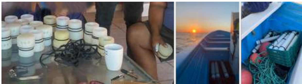
Figura 5.2. Preparación y traslado de los equipos detectores F-POD para su colocación, para el seguimiento de la monitorización acústica de vaquita marina.
