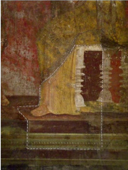
19 – Villa dei Misteri, test de nettoyage d'une fresque historiée.
